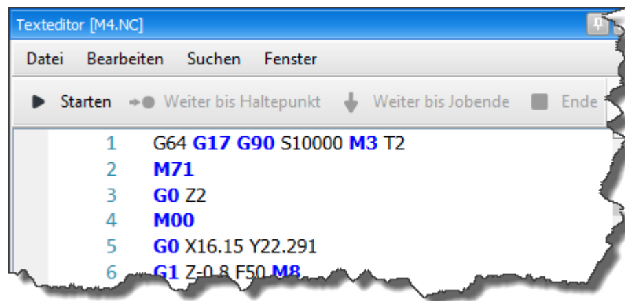
Abbildung 1: Durch klicken auf "Starten" wird die DIN66025 Datei zeilenweise ausgeführt
