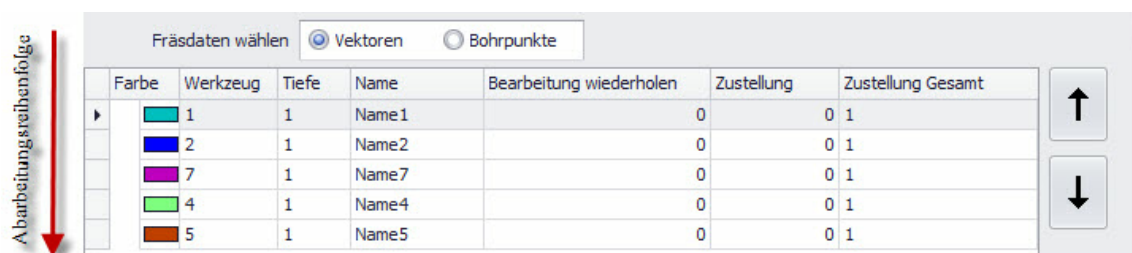
Abbildung 4: Die Option "Werkzeug wechseln" ist aktiv. Die Reihenfolge der Abarbeitung kann durch Auswählen des Werkzeuges und durch die Betätigung der Pfeil-Buttons verändert werden.
